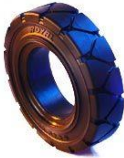
نمونه چرخ لیفتراک که از طریق روکش غلطک تولید شده
